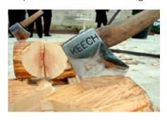
Durante el siglo XIX el hacha se fabricaba en los talleres de forja (ferrerías), utilizando el metal en bruto. La experiencia fue diseñando un modelo «vasco» de herramienta con mucho peso en la cabeza y poco en la boca, y esa fue la herramienta que se utilizó hasta bien entrado el siglo XX.
